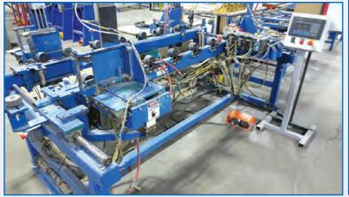
KVAL 700D DOOR FRAME MACHINE WITH ALLEN BRADLEY PANEL VIEW CONTROL, ROLLER CONVEYOR S/N  $46035\,\mathrm{W}/$  (2) DUST COLLECTORS
